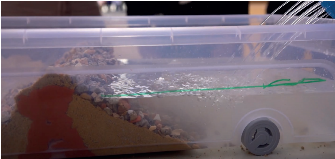
Olimpiadas de la Ingeniería. Prueba de impermeabilidad de un dique.
