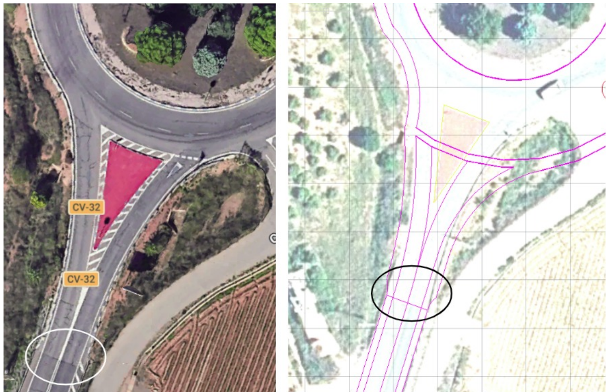
Figura 47: Zona donde se termina el arcén. Fuente: Elaboración propia
