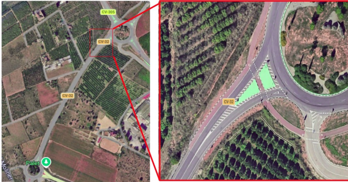
Figura 55: Conexión con el carril bici existente. Fuente: Google Maps
