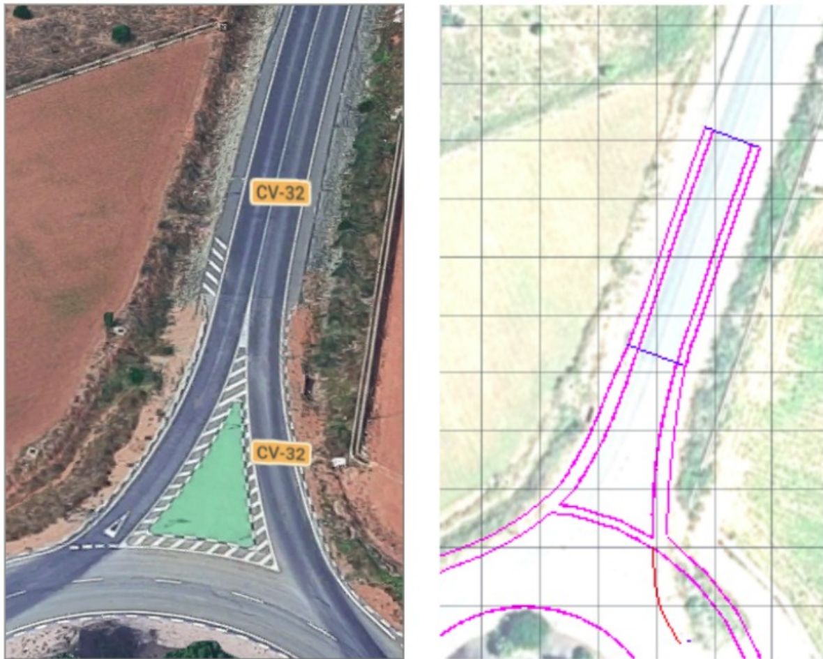
Figura 23: Desaparición del arcén en la zona norte de la glorieta situada al norte del paso superior. Fuente: Elaboración propia
