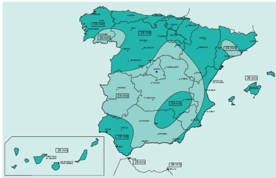
Figura 62. Mapa de ISOTACAS para la obtención de la velocidad de referencia del viento. (Fuente. Ministerio de fomento, 2007).
